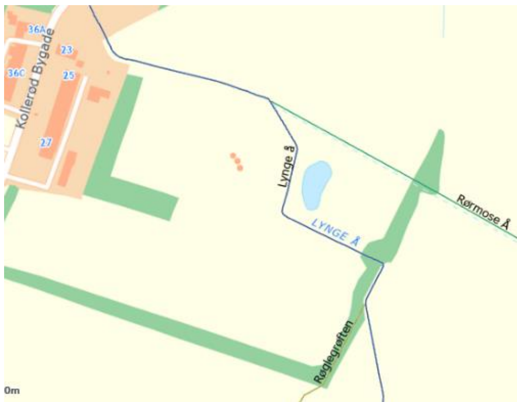
Figur 6 Regulativvandløb i nærheden af sydlige restaureringsstrækning. Tilløb fra Rørmose Å og Røglegrøften er rørlagte.
